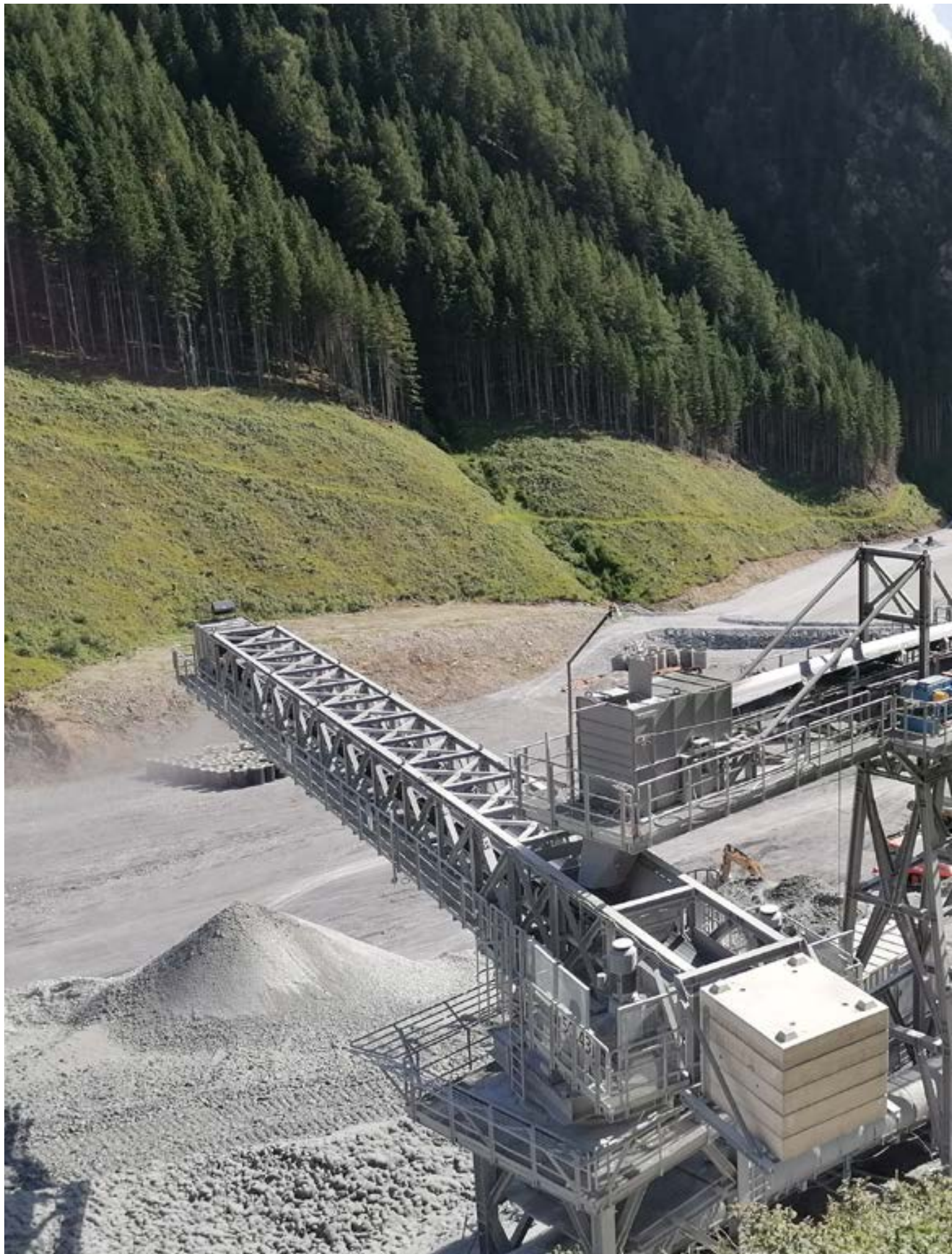
Blick auf die Deponiefläche - Förderbänder bringen das Ausbruchsgestein exakt dorthin, wo es aufgeschüttet wird. Vista sulla superficie di deposito - i nastri trasportatori conferiscono la roccia scavata direttamente a deposito.
